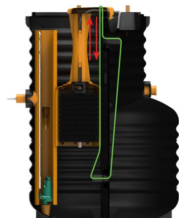
Схема прочистки нижнего патрубка
